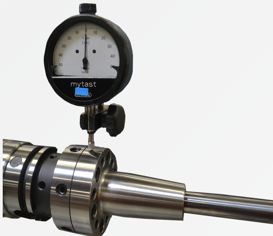
Fig. 10 : mise à zéro du comparateur
