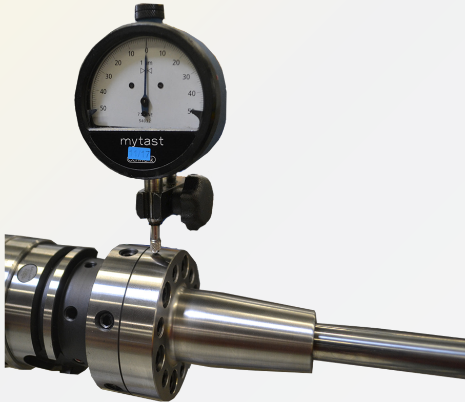
Fig. 13 : vérifier le faux-rond
