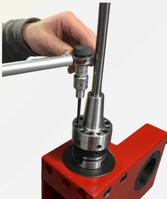
Fig. 7 : serrage des vis de fixation au couple
