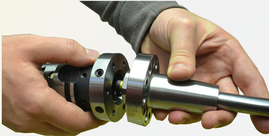
Fig. 5 : adapter le module bride dans le module adaptateur de positionnement
