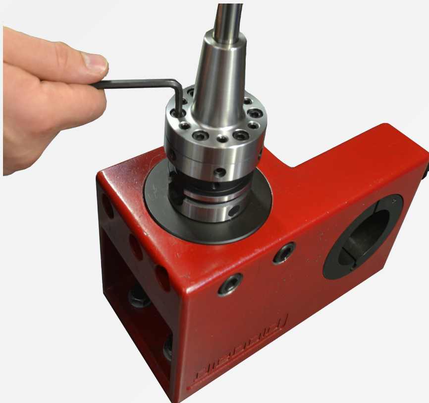
Fig. 6 : serrage léger des vis de fixation
