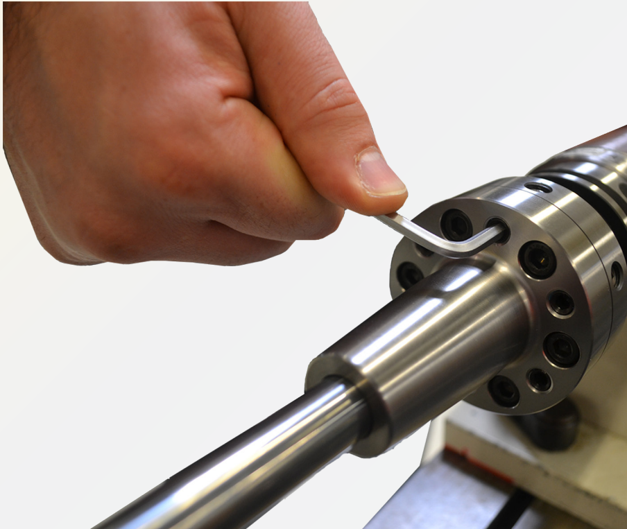
Fig. 17 : positionnement de l'angle à l'aide des vis de réglage d'angle
