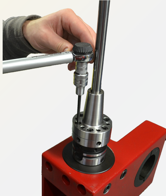
Fig. 12 : serrage des vis de fixation au couple
