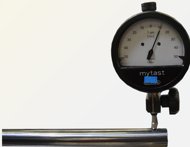
Fig. 15 : recherche du point de mesure le plus haut
