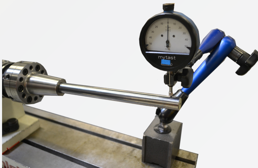
Fig. 16 : mise à zéro du comparateur
